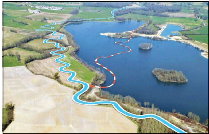
Montage photographique montrant l'ancien tracé de la Veyle aujourd'hui dans le plan d'eau et le nouveau tracé. (Source SMVV)
